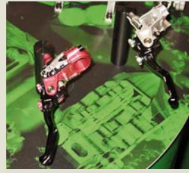
Páky Hope mají dvojici regulačních koleček na horní straně páčky, přičemž jedno nastavuje vzdálenost páčky od řídítka a druhé samozřejmě okamžik dosednutí destiček na kotouč.
