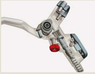
Avid u brzd Elixir namísto kolečka na vrchu nádobky použil otočný prsteneček (červená barva) a před něj aplikoval černé kolečko regulace vzdálenosti páčky od řídítka.
