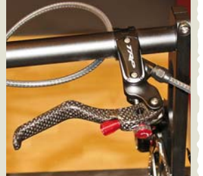
Luxusnější řada brzd Tektro nabízí díky regulaci vzdálenosti táhla pístku v páce možnost výrazně ovlivnit sílu vyvinutou na páce, a tudíž i výkon brzd. Nejde o nastavení kontaktu destiček, ale výložně o regulaci pákového poměru.
