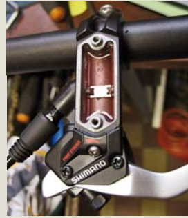
Shimano si počkalo až nakonec a přišlo s vlastním řešením ovlivnění délky volného chodu páčky, kdy jdou destičky rychle ke kotouči, ale ještě na něj netlačí silou. Délku tohoto chodu s mechanismem Servo Wave lze na páce nastavit šroubkem s označením Free Stroke.
